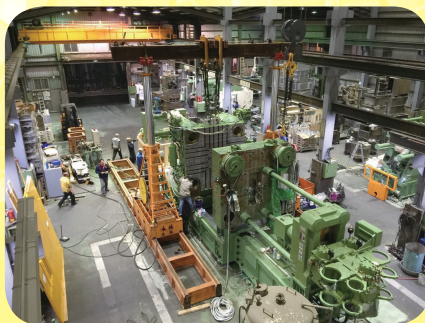
大型進口設備吊裝定位
