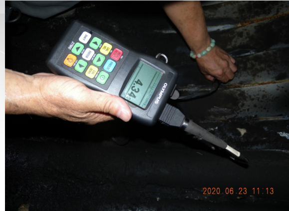
外盤爐管管壁測厚值4.3 mm (原製造厚度4.0mm)。
